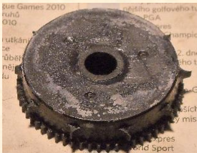
Špatně odmaštěný a obroušený povrch, lepidlo neudrželo pouzdro.
