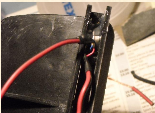
Vibrační motůrek pod šachtou
